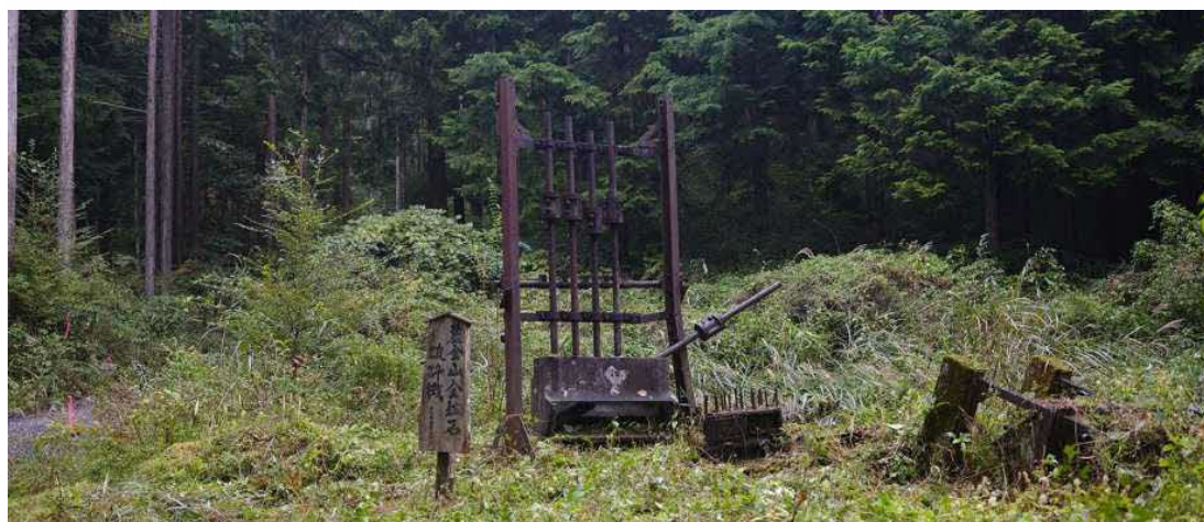
麓金山精錬所跡にある金鉱石の破碎機
