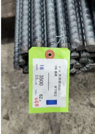
▲現場毎に配色を変えている荷札
