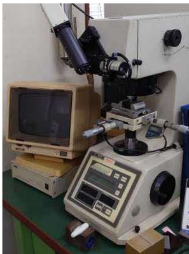
▲ 同社の分析室に配備されている「微小硬さ試験機」(左)、「元素分析装置」(中)、「走査型電子顕微鏡」(右)
